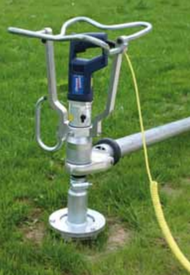
Eindrehmaschine für Schraubfundamente.
